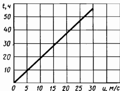
Рис. 51. Промежуток времени, необходимый для развития предельного по высоте h_\infty волнения при скорости ветра u (м/с)
